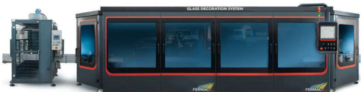
Fig. 7: Système FLEX JetArt F4200N de Fermac (8 stations jet d'encre) avec flammage Pyrosil UVTREAT intégré.
