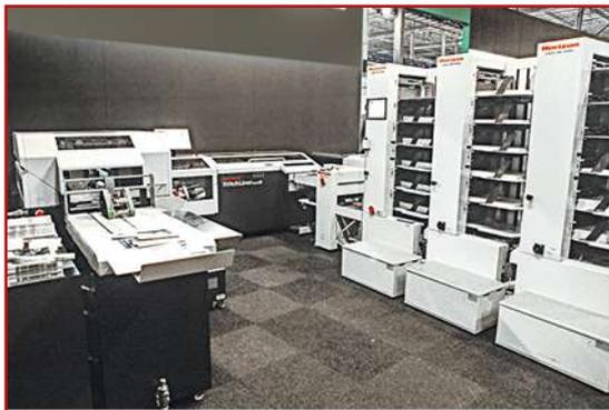
9. Horizon Stitchliner Mark-III avec tour d'assemblage et massicot.
