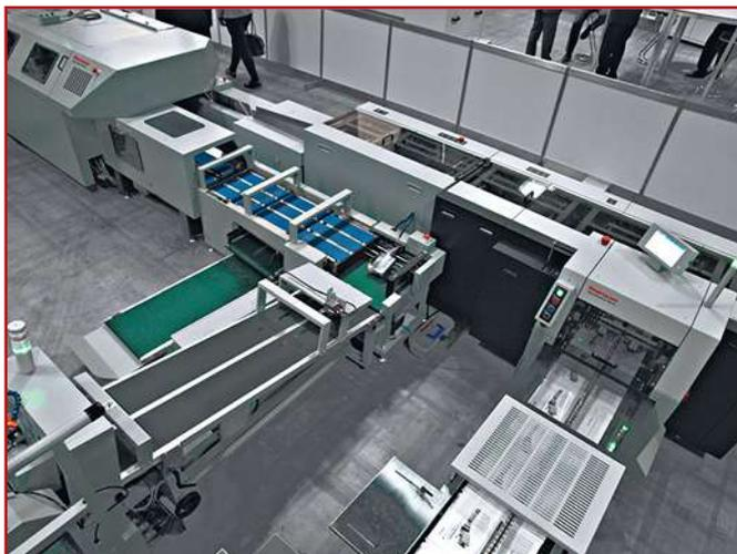
17. Ligne de reliure Horizon avec margeur de blocs-livres CBF-SB.
