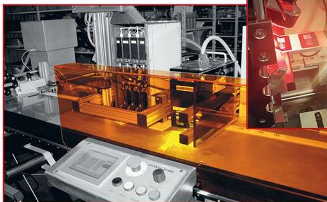
**Nouvelle chaîne de fabrication NFC des Impressions Modernes permettant la fabrication sur mesure, l'intégration des puces NFC, l'impression couleur, l'encodage et le contrôle.**
