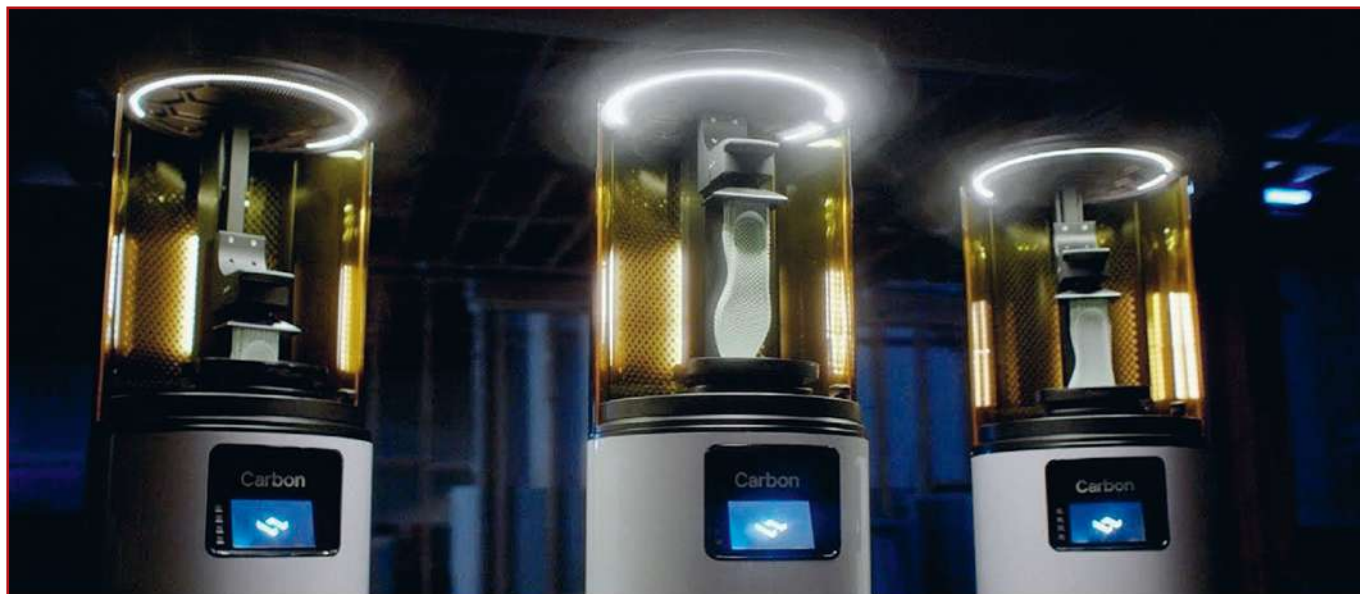
Production de semelles en masse pour Adidas via les imprimantes 3D de Carbon.
