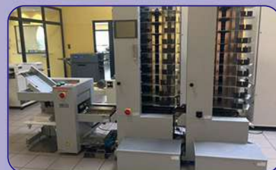
Assembleuse à succion HORIZON VAC 1000 de 2016, 20 postes, format 35x50 cm avec stacker de réception ST-40
