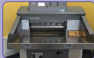
Massicot automatique programmable pour petits formats POLAR 66 de 2008, 67 cm, avec cellules
