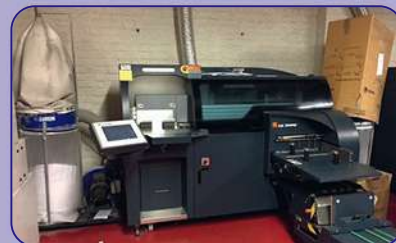
Thermoreducteur monopince automatique CP BOURG BB3002 de 2010 (système EVA) avec convoyeur de sortie BBR, 385x320 mm
