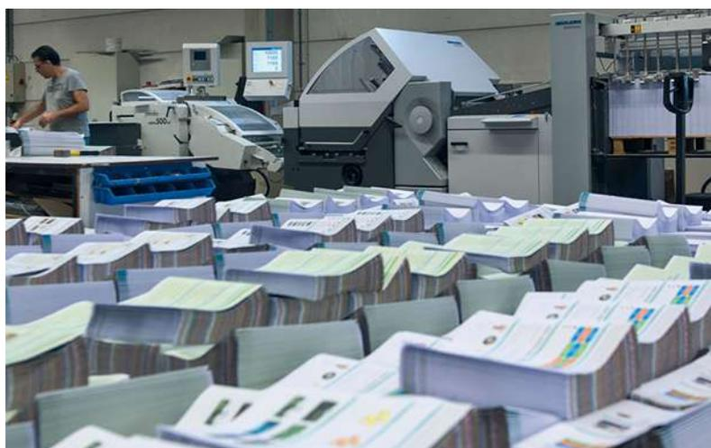
Récemment, la Drukkerij VD à Temse a installé une Stahlfolder KH 82P avec alimentation par palette PFX et un système de transport Polar PACE pour les rogneuses.
