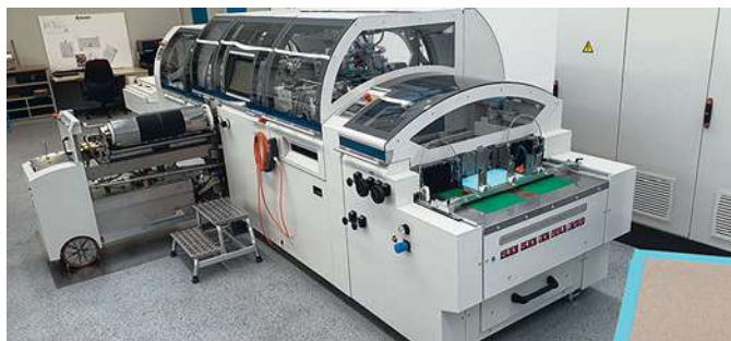
La couverturière Kolbus DA 370 permet la production automatique de couvertures de livres et d'albums photo, de dossiers, de posters, de classeurs, de calendriers et de plateaux de jeu à raison de 65 cycles/minute.
