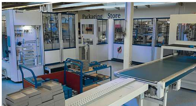
La Box Line wrapper BLW 200 est le fruit d'un nouveau développement centré sur le formage mécanique et l'habillage de boîtes pliantes vierges destinées à la production d'emballages de luxe.
