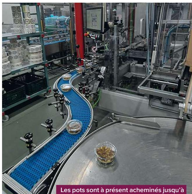
Les pots sont à présent acheminés jusqu'à l'encartonneuse par un convoyeur.
