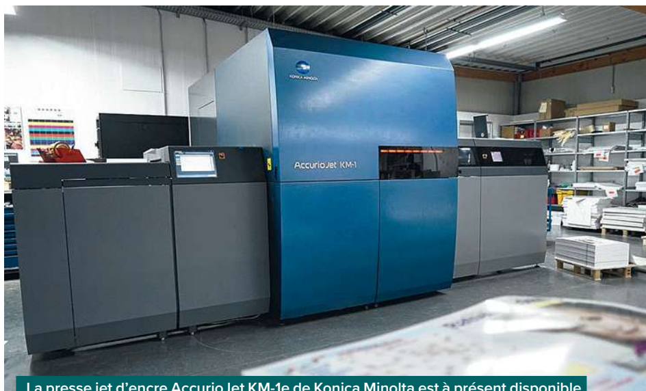
La presse jet d'encre AccurioJet KM-1e de Konica Minolta est à présent disponible en version haute définition (HD), élargissant ainsi les possibilités d'applications, dont l'emballage.
