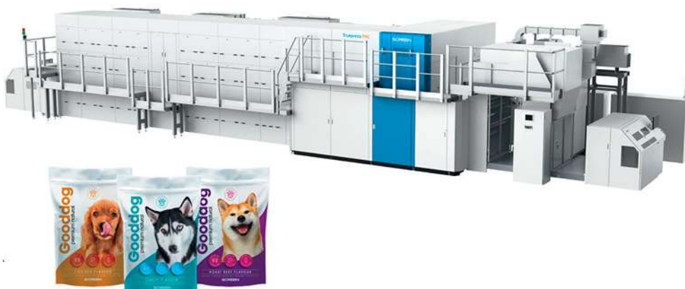
La presse jet d'encre Truepress PAC830F (CMJN + blanc) de Screen est destinée à l'impression d'emballages souples en PET et OPP en petits lots.
