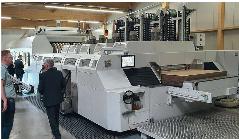
La nouvelle presse flexographique à découpe rotative RD 1155 pour la fabrication de boîtes en carton ondulé imprimées, en démonstration chez Packconcept.
