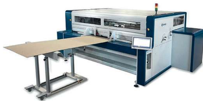
L'AutoBox AB 310 permet de fabriquer de petites quantités de boîtes en carton ondulé.
